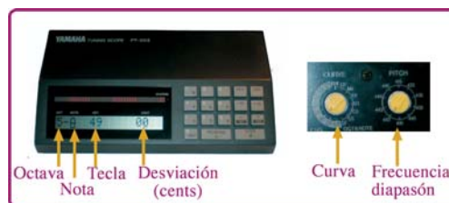
Yamaha Tuning Scope PT-100II empleado por los técnicos para la afinación de pianos
