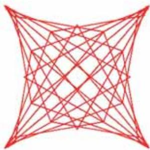
Con Geogebra conseguimos una astroide definiendo un deslizador  $a \in [0,360]$  con incremento 10 y una semirrecta con trazo:
