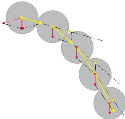
Sólo el arco catenario se sostiene a sí mismo. Gaudí hizo extenso uso de él aunando así la forma con la estructura. Pero sus obras no estaban destinadas a salvar ríos. Como puente, el arquitecto prefiere el arco parabólico. A la vista resulta prácticamente indistinguible del otro. El primero se caracteriza por soportarse a sí mismo; el segundo, por soportar lo que tiene encima. ■
