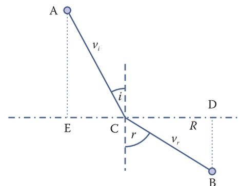
La velocidad del rayo  $AC$  en el medio superior es  $v_i$ , e incide con un ángulo  $i$  y al llegar a  $C$  pasa a un medio con densidad
