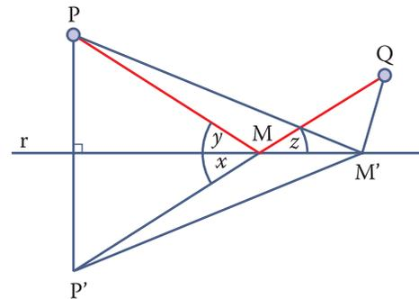
Supongamos que queremos ir de un punto  $P$  a un punto  $Q$  por el camino más corto, pero tocando en algún punto  $M$  a la recta  $r$ . ¿Cuál será ese punto  $M$ ? Para encontrarlo basta con calcular el simétrico de  $P$  respecto de  $r$ ,  $P'$  y unir mediante una recta  $P'Q$ . El punto de corte de esta recta con la recta  $r$  será el punto  $M$  buscado. Y es evidente que los ángulos  $z$  e  $y$  son iguales al ser ambos iguales al ángulo  $x$ .
