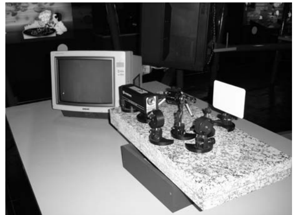
Módulos del Laboratorio Experimenta: cálculo de la velocidad de la luz y experimento de Michelson y Morley
