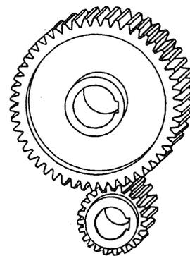
Figura 1. Dos ruedas dentadas acopladas
