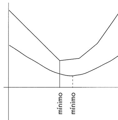
*Sorpresa:* La gráficas de la función desplazamiento (trozos de rectas) y de la función desplazamiento modificada (hipérbola) son las que aparecen en la figura y sus mínimos no coinciden.
