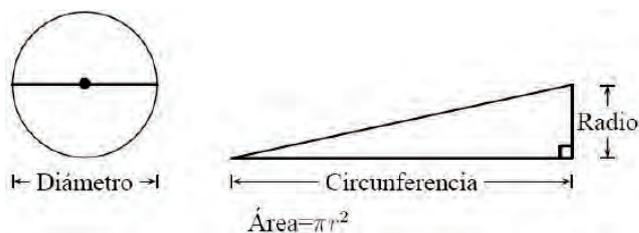
Figura 8: Cuadratura aproximada del círculo según Arquímedes.
