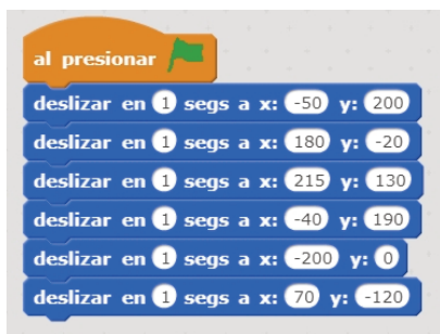
Figura 5. Dos propuestas diferentes para definir el movimiento del balón, mediante definición de desplazamientos entre puntos en el plano (izquierda) y mediante una dirección inicial aleatoria y una repetición de pasos (derecha).
